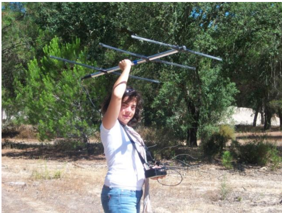
A direcção do sinal emitido pelas corujas é determinada através da antena direccionada (yagi), ligada a um rádio. Usa-se uma bússola para registar o azimute.
